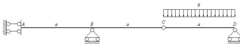
calcolare con il PLV la reazione  $R_B$ .
